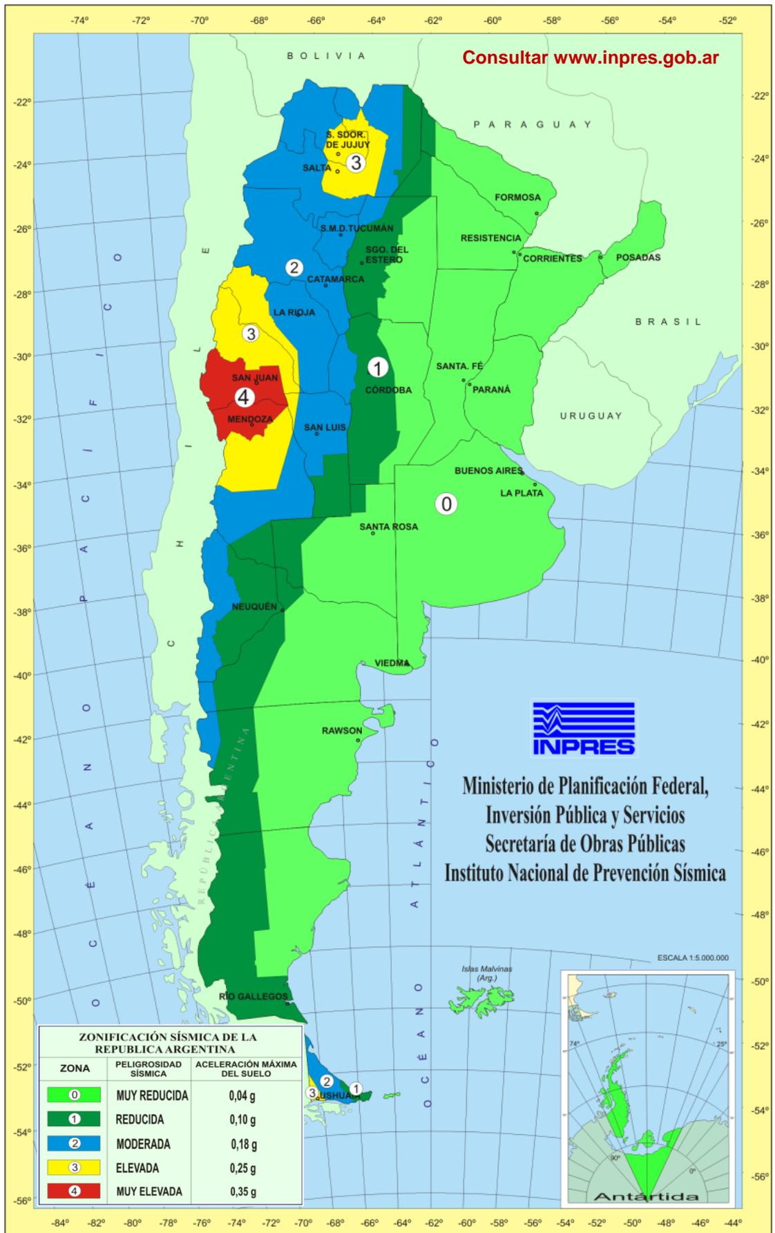
**Figura 2.1. Zonificación sísmica de la República Argentina.**
