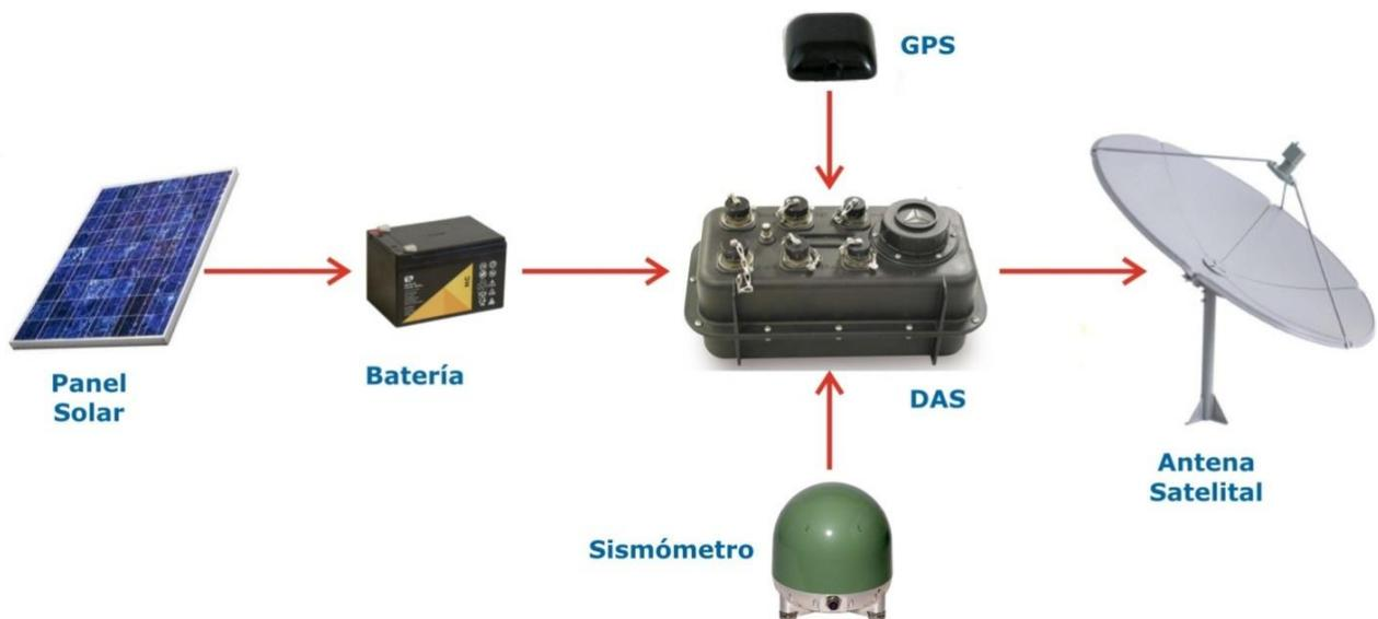
Figura 2. Componentes de una estación sismológica
