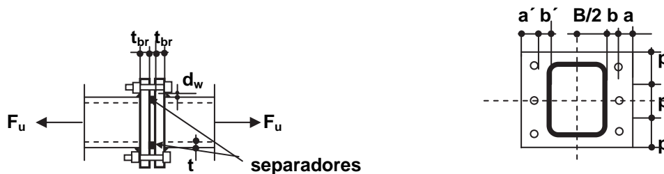
Figura C.9.5.1. Brida abulonada en dos lados opuestos con separadores. Tubo rectangular.
